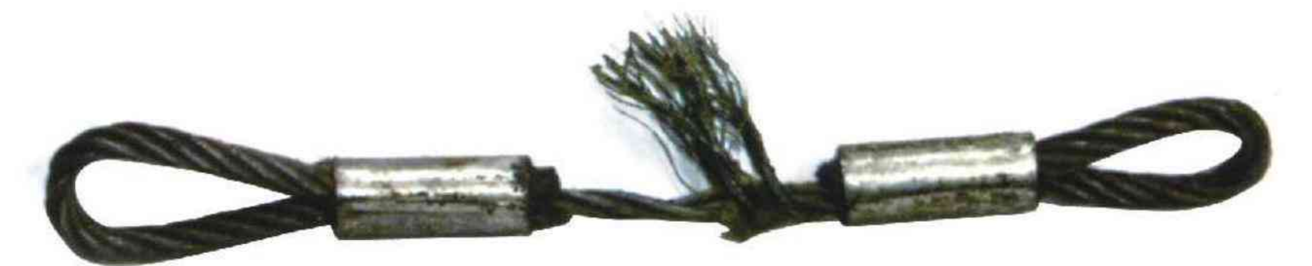
Breaking force test result 破坏性实验结果
